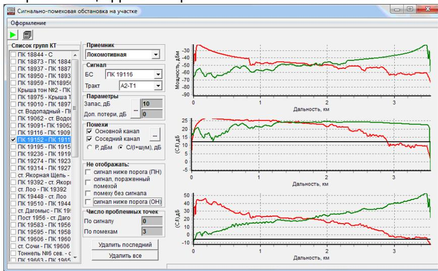
При выполнении работ по ЧТП сети, где радиопокрытие необходимо обеспечить на протяженных не площадных участках (железная или автомобильная дорога, речные фарватеры, трубопроводы и т.д.) используется функционал, обеспечивающий построение диаграмм уровней сигналов и помех, а также отношений «сигнал/помеха» по основному и соседнему
