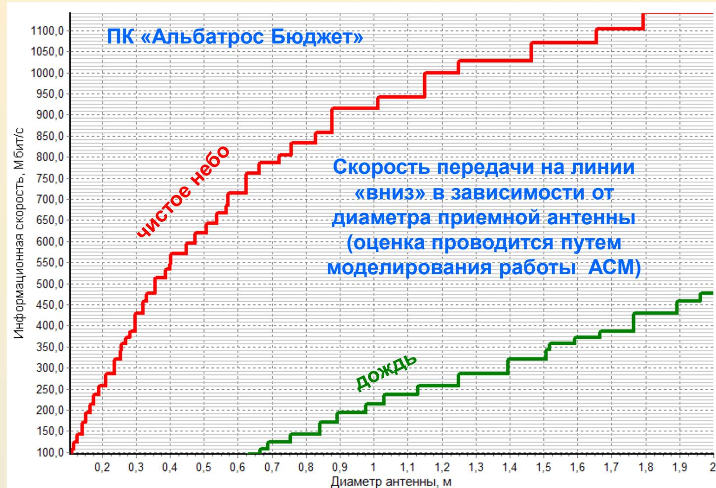
**Вывод:** пропускная способность одного луча спутников системы «СКИФ» при диаметре антенн приемных станций от 1.0 до 1.8 м составит от 200 до 450 Мбит/с в условиях дождя и от 900 до 1100 Мбит/с в условиях «чистое небо»
