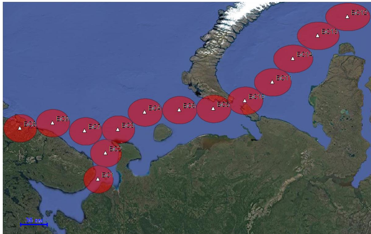
Рис.3 Пример радиопокрытия участка СМП сетью HAPS
