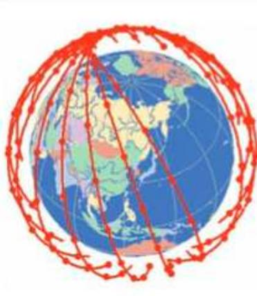
а) Наклонные орбиты, конструкция Уолкера
